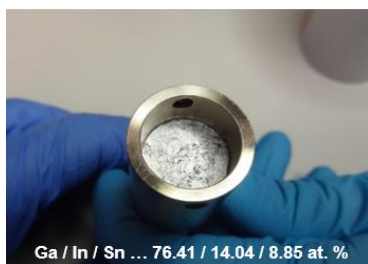
Figura 10. Mezcla eutéctica de galinstan y resultados experimentales obtenidos (IATP, Julio de 2022 Lisboa)
